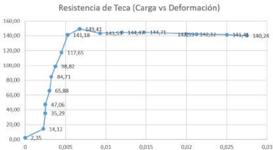
Figura 1. Grafica del comportamiento de Teca mediante carga aplicada en Kg y Deformación en cm.
